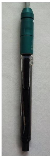
Obr. 2. Fotografie a schématické znázornění samostatné (A) a kombinované (B) fluoridové iontově-selektivní elektrody. Uspořádání elektrod na fotografiích odpovídá schématům.
